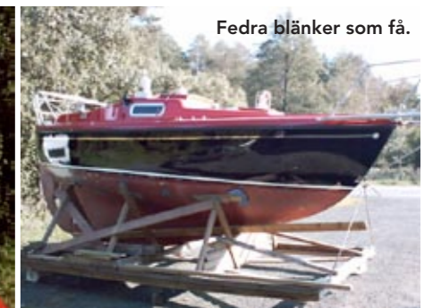
Mastfoten är förstärkt och akterpulpiten är nytillverkad.
